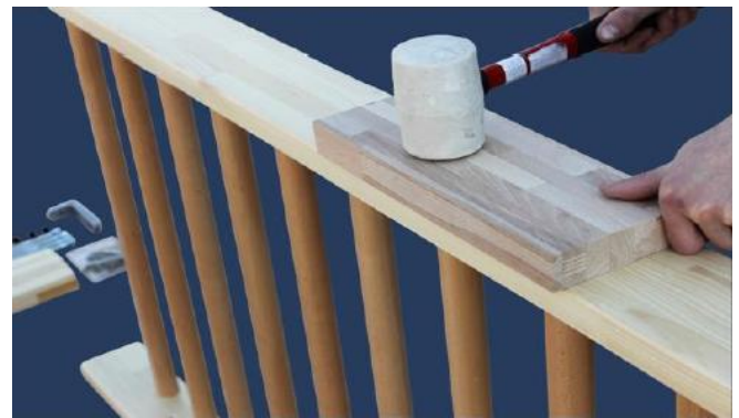
4. Sla met behulp van een houtblokje en een rubberen hamer de sporten goed in de zijplanken als nodig.
