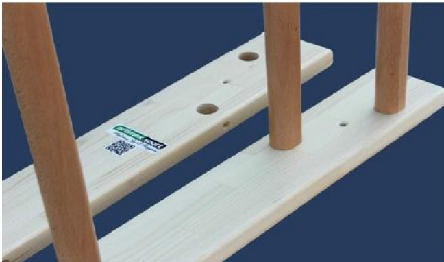
3. Plaats de tweede zijplank. Begin aan een uiteinde van de tweede plank en druk de sporten een voor een voor een lichtjes in het bijbehorende gat, totdat alle sporten ook in de tweede zijplank bevestigd zijn.
