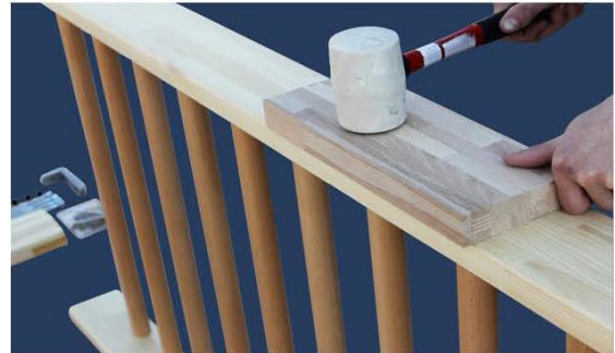
2. サイドレールに次から次へと横木を差し込む。完全に埋め込むために必要な場合、ゴムハンマーで叩く。
