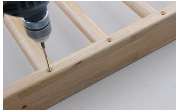
4. Fixer les barreaux au dos de l'espalier
