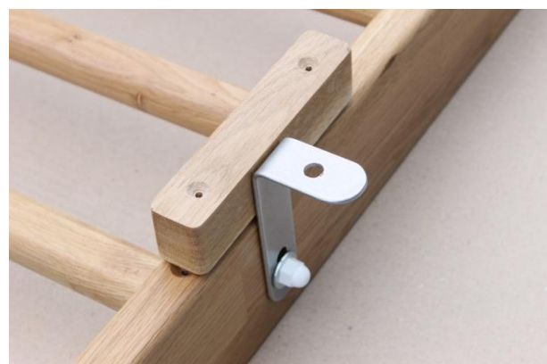
5. Abstandhalter mit Schrauben auf der Rückseite fixieren. Die Montagewinkel (4 Stk.) innen – oder außenseitig montieren.
