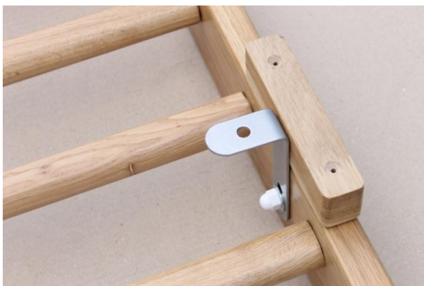
5. Abstandhalter mit Schrauben auf der Rückseite fixieren. Die Montagewinkel (4 Stk.) innen – oder außenseitig montieren.
