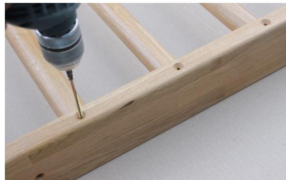
4. Mit den Schrauben die Sprossen auf der Rückseite der Sprossenwand fixieren.
